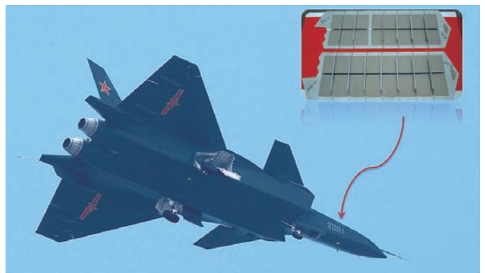
图1 首次采用搅拌摩擦焊接结构的中国新一代战斗机（J20）
